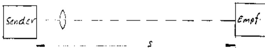
Mit einem Oszilloskop wird die Phasenverschiebung zwischen Sende- und Empfangssignal gemessen. Der Quotient  $s/t$  ergibt die Lichtgeschwindigkeit.
